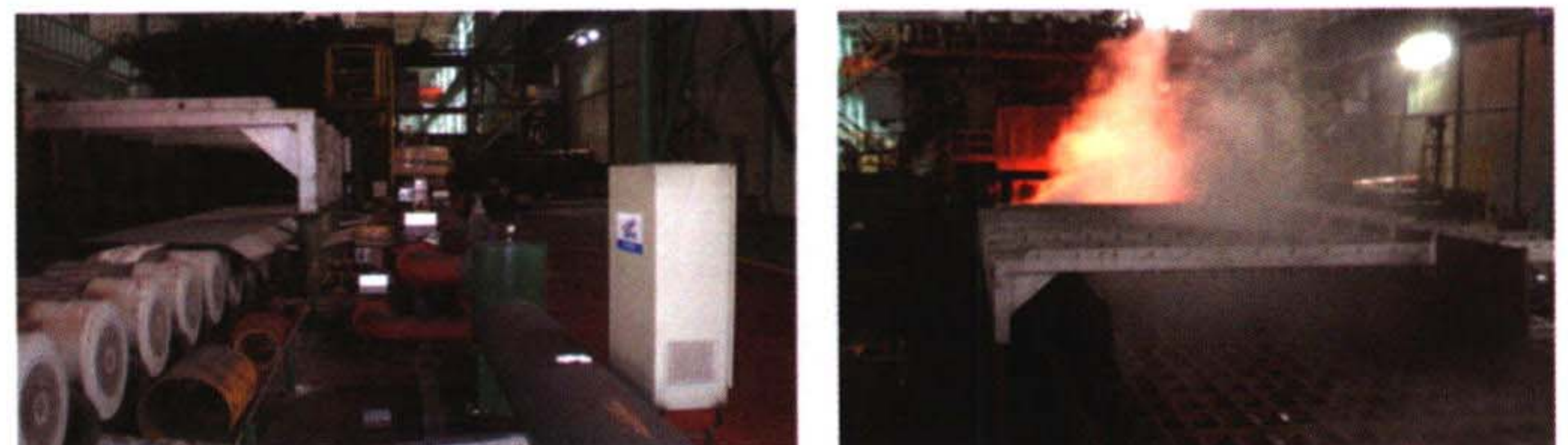
层流均匀快冷、超快冷系统 与武钢一钢轧合作对 1700 轧机均匀快冷技改已成功投入运行
