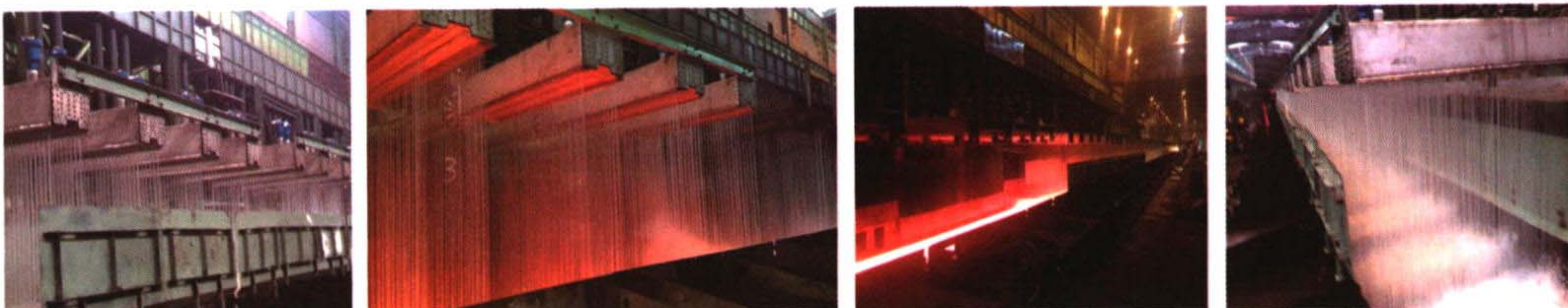
层流均匀快冷、超快冷系统 与武钢一钢轧合作对 1700 轧机均匀快冷技改已成功投入运行
