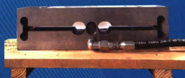
山钢轧制力传感器的安装
