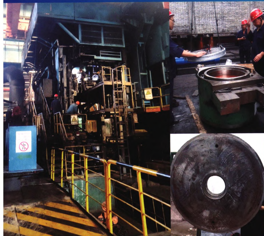
山钢轧制力传感器的安装
