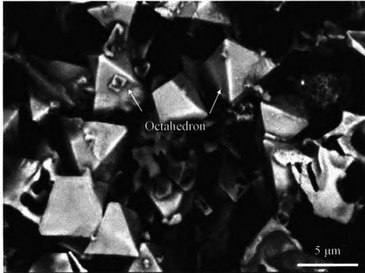
**摘要:** 利用等离子熔覆技术制备 Ni 基涂层,用直接加入的 WC 和原位合成的 TiC 复合增强,分析原料体系中(Ti+C)和 WC 的含量变化对涂层物相组成、微观组织、显微硬度和滑动摩擦磨损性能的影响。结果表明:WC 在熔池中溶解,分解出 W 和 C,W 扩散进入原位生成的 TiC 中,形成(Ti,W)C 固溶体,W 的扩散不充分使(Ti,W)C 呈现核壳结构。随原料中(Ti+C)含量的增多(0~20%)和 WC 相应含量的减少(40%~20%),WC 溶解程度增大,(Ti,W)C 颗粒形貌由八面体转变为椭圆形;(Ti,W)C 生成量的增多使涂层上部硬度提高,WC 聚集沉底现象的减弱使涂层下部硬度下降,与基材 Q235 之间形成较平稳的硬度梯度。涂层耐磨损性能显著优于基材,当(Ti+C)和 WC 的含量分别为 10%和 30%时,涂层的磨损体积为基材的 8.33%。
