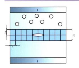
摘要: 孔隙率是影响氧化皮与钢基体界面裂纹扩展的重要因素,采用分子动力学模拟软件 LAMMPS 建立模型 I(定孔缺陷对式模型) 两种模型,从抗拉强度、中心对称分析(CSP)以及界面局部应力分布3个方面研究了孔隙率对于界面裂纹扩展的影响。结果表明,相同孔隙率下,模型 II 比模型 I 的抗拉强度低,表明孔缺陷分布范围比孔缺陷的尺寸对于材料的抗拉强度影响更大。同时裂纹扩展时动态不稳定性导致裂纹非对称性扩展,孔隙率的增加会阻碍应力增长和裂纹扩展速度,增强裂纹扩展的不对称性。当孔隙率达到 9%时,在界面裂纹扩展后,模型 I+x 方向裂尖偏转界面上方孔缺陷,模型 II 则为界面裂纹扩展后, 模型 I+x 方向裂尖偏转界面上方孔缺陷,模型 II 则为界面裂纹扩展后,上方孔缺陷融合发展。
