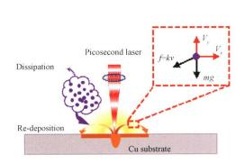
摘要: 无修饰的金属疏水表面受到广泛关注,尤其是具有超高疏水性表面的制备方法逐渐被重视。通过皮秒激光烧蚀、电化学抛光和电化学沉积的顺序加工方法在铜表面制备一系列具有不同微观特征的乳突织构。系统研究激光功率、重复频率、扫描速度和扫描次数对乳突织构表面形貌及疏水性的影响,并分析表面润湿性的转化机理。研究结果表明,激光功率 9 W、重复频率 2 MHz、扫描速度200 mm/s、扫描次数 20 次时,跨尺度乳突织构表面静置30 d 后可获得超高疏水性(接触角161°,滚动角1°)。储存30 d 后,亲水性的 Ni、CuO 转化为疏水性的 NiO、Ni(OH)2、Cu2O,以及含 C 有机物的吸附促成了乳突织构表面润湿性的转化。
