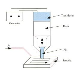
摘要: AA6061-T6 铝合金因较高的比强度、良好的可成型性广泛应用于汽车工业中,但较差的空蚀性能极大的降低了其使用寿命。利用超声波冲击技术在 AA6061-T6 表面制备了塑性形变强化层,研究了塑性形变强化层的微观组织、残余应力及显微硬度分布和抗空蚀性能。结果表明:超声波冲击强化后铝合金表面择优取向由原始的(200)转变为(111),并形成约 140 μm 塑性变形层。与未强化试样相比,强化试样表面显微硬度提高了 80.7%,并形成 140 μm 硬化层;表面植入残余压应力达到-259 MPa,残余压应力层深达到 700 μm。超声波冲击强化处理后的空蚀性能提高 2.36 倍;空蚀表面形貌分析表明强化后试样空蚀机制由韧性断裂转变为脆性断裂和疲劳破坏。研究表明超声波冲击强化后试样表面晶粒细化、择优取向转变、硬度提高以及较高残余压应力等增强了材料的抗空蚀性能。
