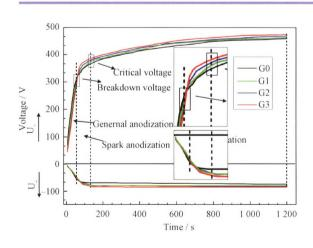
摘要:微弧氧化是轻合金表面防腐的关键手段,复合涂层中石墨烯的防腐减摩潜能也被逐渐挖掘验证。详细介绍了石墨烯添加剂对电解液和电参数,以及膜层结构和性能等方面影响作用的研究现状,阐述轻合金表面石墨烯复合微弧氧化层需要进一步探索的问题。电解液中添加石墨烯后,降低了阳极绝缘层击穿电压,促进了膜层的生长和新相生成;微弧氧化层中石墨烯以填充和包覆的增强相形式存在,可明显改善膜层的致密度和厚度,促进膜层防腐耐磨性能进一步提升;结合轻合金表面碳元素、相位角和阻抗等特征参数的表征分析,可以较好地验证滑动摩擦和电化学腐蚀过程中石墨烯的增强作用机理,绘制的原理示意图也更具直观性。
