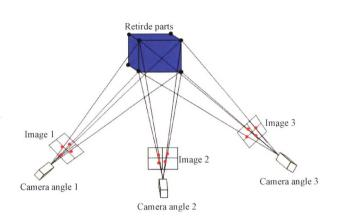
摘要:退役零件的失效程度是判断其可再制造性的关键因素之一,为克服失效程度难以快速精确量化的问题,提出一种基于图像三维重建的退役零件失效特征表征方法。针对失效特征重建精度要求高的特点,在由运动恢复形状(Shape from motion, SFM) 算法的基础上提出一种自标定全局 SFM 三维点云重建算法,利用光束平差法优化相机焦距、径向畸变参数,实现了相机自标定,增加了全局 SFM 算法的鲁棒性;以重建有效三维点数量占比、点云完整度和相机位姿准确度为评价指标,构建了重建精度评价模型,实现了图像三维重建精度的量化评价;提出了退役零件表面失效特征量化方法和实施流程,并定义了失效特征信息计算公式;最后,以电梯导靴为例,对其表面磨损失效特征进行了量化表征。试验结果表明,该方法可以有效地用于毫米级及以上的退役零件表面失效特征的快速量化表征。
