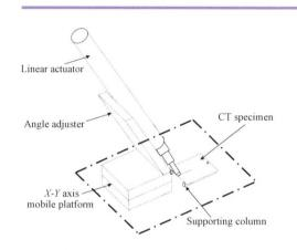
摘要:16 mm×32 mm 单晶硅片基体紧凑拉伸测试样品上尖锐裂纹的可控制备,及其在拉伸载荷作用下的稳态扩展,是微桥法薄膜断裂韧性测试得以实现的关键。相较于紫外激光切割,采用红外激光切割方法在基体背面制备出了锯齿状的背槽,并通过控制位移加载步幅和球形压头均衡加载,实现了三点弯曲法基体尖锐裂纹的可控制备。该基体裂纹具有梯度形貌特征,对加载过程中的"载荷-位移"曲线以及表面裂纹扩展过程进行了考察,揭示了梯度形貌对裂纹失稳扩展的抑制作用。基体尖锐裂纹的可控制备及其在拉伸测试中的稳态扩展,为微桥法的标准化测试奠定了基础。
