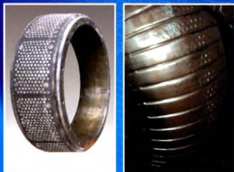
高胜陶瓷科技斥资2.1亿元致力于电力、水泥、钢铁等行业立磨辊套和磨盘衬板的磨损课题研发。陶瓷颗粒增强基耐磨复合材料是利用颗粒自身的高强度、高熔点、高硬度，保护基体不受磨损，同时金属基优良的韧性把陶瓷颗粒组合在一起并支撑颗粒，二者相互协同作用，完善结合，具有超强的耐磨性能。
