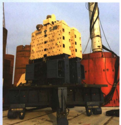
福建平潭海峡跨海大桥YZ-400双联动
