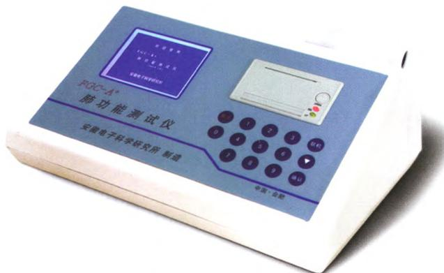
**FGC-A<sup>+</sup>肺功能测试仪**采用先进的微电脑处理系统，通过呼吸流量传感器，测量出人体的呼气功能和吸气功能，再经过分析、处理，由液晶显示器（LCD）显示和图形打印机打印结果。可以同时检测出人体的用力肺活量、肺活量、最大通气量、气道阻力、小气道状况等方面的数据及其曲线，并对受测者的肺功能障碍进行自动分型。
