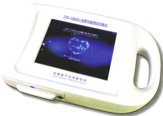
**ZXG-G自动心血管功能测试诊断仪（便携式一体机）**由主机、脉搏传感器、超大真彩液晶触摸屏、超宽高速热敏微型打印机构成；一体化结构，集数据采集、显示、打印于一体；体积小巧、便于出诊携带。仪器通过高灵敏度的脉搏传感器采集被测者的脉搏信息，同时输入被测者的身高、体重、血压值作为参数。根据人体循环系统弹性腔模型理论为基础，对模型进行分室网络分析，用线性相关算法推导出一系列计算公式。这些公式经过非线性补偿和临床经验参数修正，便能获得一组反映心脏功能、血管状况、血液状态及微循环功能的35项参数及64项专家辅助诊断信息。具有无创检测快速，数据准确，使用方便等特点。
