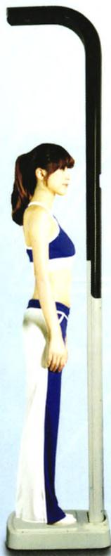
本仪器是为测量身高、体重设计制造的。它以可靠的硬件设计和科学的软件技术相结合,采用CS-51单片微处理技术和高速、高精度A/D转换技术,实现身高和体重的自动测量。测量结果既可以显示和打印出来,又能与计算机通讯联网,把数据传给计算机,以实现进一步的处理,还特别设计了语音报告检测结果的功能。可广泛用于医院、学校、体检站等场合的身高、体重测量。
