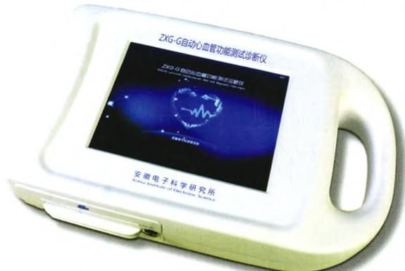
ZXG-G自动心血管功能测试诊断仪(便携式一体机)由主机、脉搏传感器、超大真彩液晶触摸屏、超宽高速热敏微型打印机构成;一体化结构,集数据采集、显示、打印于一体;体积小、便于出诊携带。仪器通过高灵敏度的脉搏传感器采集被测者的脉搏信息,同时输入被测者的身高、体重、血压值作为参数。根据人体循环系统弹性腔模型理论为基础,对模型进行分室网络分析,用线性相关算法推导出一系列计算公式。这些公式经过非线性补偿和临床经验参数修正,便能获得一组反映心脏功能、血管状况、血液状态及微循环功能的35项参数及64项专家辅助诊断信息。具有无创检测快速,数据准确,使用方便等特点。
