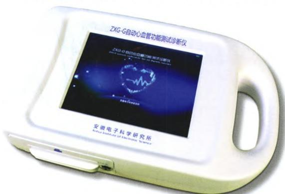
**ZXG-G自动心血管功能测试诊断仪（便携式一体机）**由主机、脉搏传感器、超大真彩液晶触摸屏、超宽高速热敏微型打印机构成；一体化结构，集数据采集、显示、打印于一体；体积小巧、便于出诊携带。仪器通过高灵敏度的脉搏传感器采集被测者的脉搏信息，同时输入被测者的身高、体重、血压值作为参数。根据人体循环系统弹性腔模型理论为基础，对模型进行分室网络分析，用线性相关算法推导出一系列计算公式。这些公式经过线性补偿和临床经验参数修正，便能获得一组反映心脏功能、血管状况、液状态及微循环功能的35项参数及64项专家辅助诊断信息。具有无创检测快速，数据准确，使用方便等特点。
