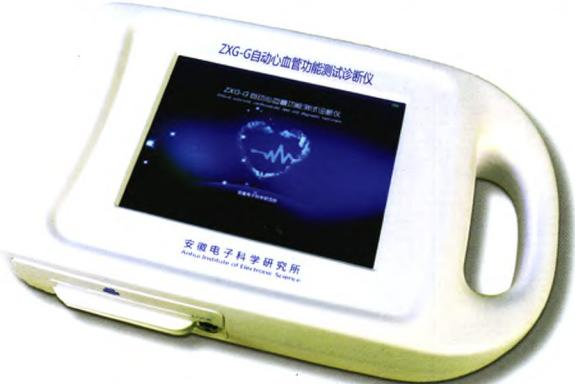
**ZXG-G自动心血管功能测试诊断仪（便携式一体机）**由主机、脉搏传感器、超大真彩液晶触摸屏、超宽高速热敏微型打印机构成；一体化结构，集数据采集、显示、打印于一体；体积小巧、便于出诊携带。仪器通过高灵敏度的脉搏传感器采集被测者的脉搏信息，同时输入被测者的身高、体重、血压值作为参数。根据人体循环系统弹性腔模型理论为基础，对模型进行分室网络分析，用线性相关算法推导出一系列计算公式。这些公式经过非线性补偿和临床经验参数修正，便能获得一组反映心脏功能、血管状况、血液状态及微循环功能的35项参数及64项专家辅助诊断信息。具有无创检测快速，数据准确，使用方便等特点。
