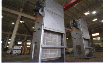
内进流网板格栅除污机（金属/非金属网板）
