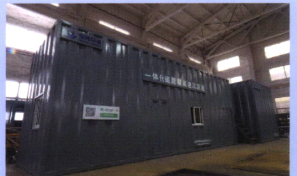
一体式钢结构磁混凝设备
