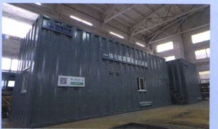
一体式钢结构磁混凝设备
