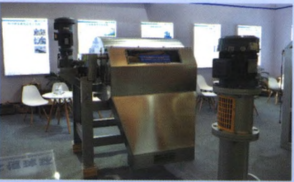
磁混凝高速沉淀池工艺设备
