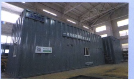
一体式钢结构磁混凝设备
