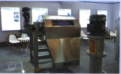
磁混凝高速沉淀池工艺设备
