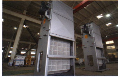
内进流网板格栅除污机(金属/非金属网板)
