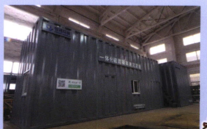
一体式钢结构磁混凝设备
