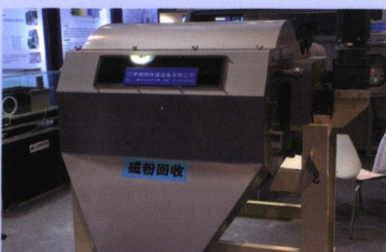
磁混凝高速沉淀池工艺设备
