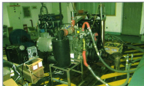
机电系整车动力系统测试平台
