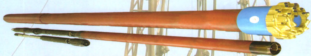
为煤层气参数井研制的绳索取芯钻具
