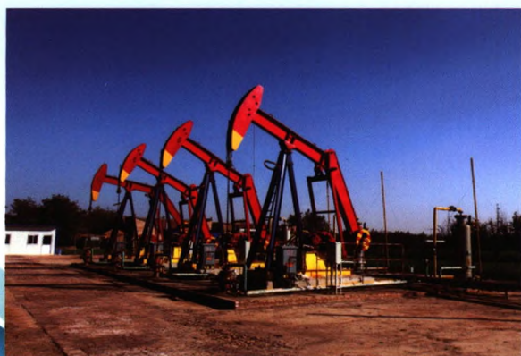
煤层气抽采井
