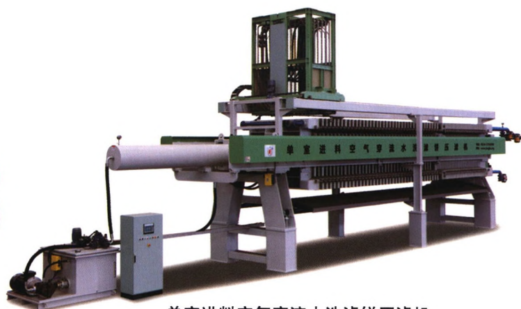
单室进料空气穿流水洗滤饼压滤机
