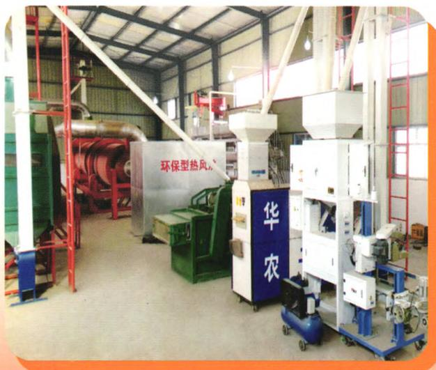
5ZTX系列棉种酸溶液脱绒成套生产线
