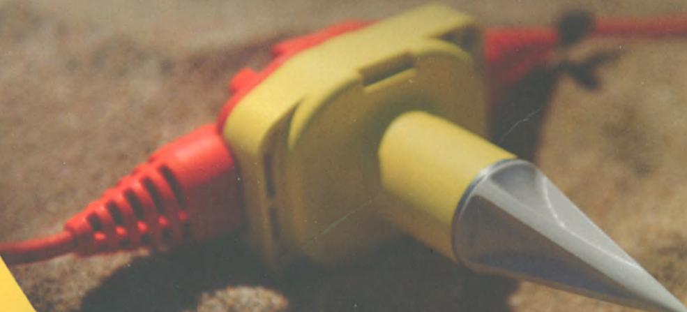
Sercel公司的DSU1是基于MEMS技术的垂直单分量数字检波器，具有宽频线性响应、低畸变特点，是高分辨地震勘探的理想选择。
