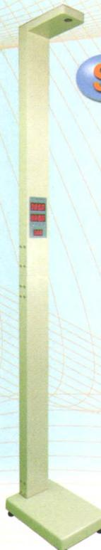
本仪器是为测量身高、体重设计制造的。它以可靠的硬件设计和科学的软件技术相结合，采用MCS-51单片微处理技术和高速、高精度A/D转换技术，实现身高和体重的自动测量。测量结果既可以显示和打印出来，又能与计算机通讯联网，把数据传给计算机，以实现进一步的处理，还特别设计了语音报告检测结果的功能。可广泛用于医院、学校、体检站等场合的身高、体重测量。
