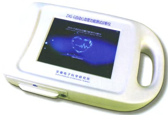
ZXG-G自动心血管功能测试诊断仪（便携式一体机）由主机、脉搏传感器、超大真彩液晶触摸屏、超宽高速热敏微型打印机构成；一体化结构，集数据采集、显示、打印于一体；体积小、便于出诊携带。仪器通过高灵敏度的脉搏传感器采集被测者的脉搏信息，同时输入被测者的身高、体重、血压值作为参数。根据人体循环系统弹性腔模型理论为基础，对模型进行分室网络分析，用线性相关算法推导出一系列计算公式。这些公式经过非线性补偿和临床经验参数修正，便能获得一组反映心脏功能、血管状况、血液状态及微循环功能的35项参数及64项专家辅助诊断信息。具有无创检测快速，数据准确，使用方便等特点。
