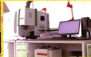
▲ ICP-OES美国进口, 主要用于多种金属离子的同时检测
