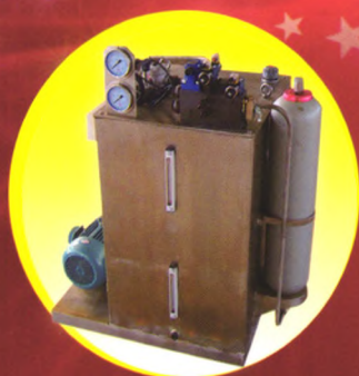
重压机液压站
