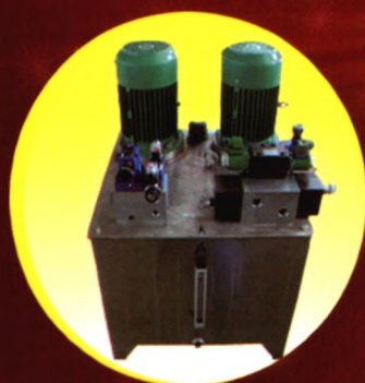
布酱机液压站
