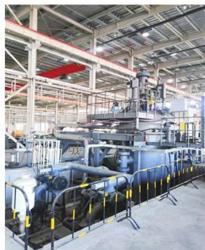
500kg多功能感应熔炼炉
