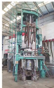
气保电渣重熔炉
