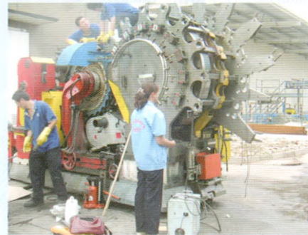
太平洋制罐（北京）有限公司 制罐机模辊的不解体修复
