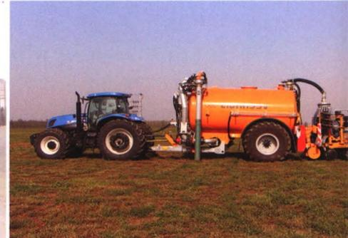
喂料上料车便于操作人员清晰地查看取料过程,自动化程度较高,配备双侧马达,使取料速度、切害力更强,大幅度提高了工作效率。沼液转运车带有GPS定位及容积监测系统;转运车可与收集车进行快速密闭接口,实现无异味、无溢流、快速收集等;转运车配有臭气过滤器;容积为:33方。专业型液肥施用罐车是非常成熟的粪肥施用罐车,能达到物理测土、精准添加、改良土壤、增产丰收的农业现代化目标。
