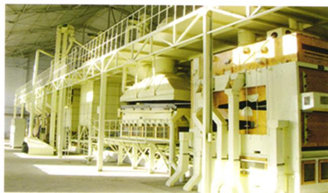
公司设计安装的5XT系列种子加工成套生产线
