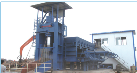
Q91Y-1250吨重型液压剪切机在河北徐水工作现场
