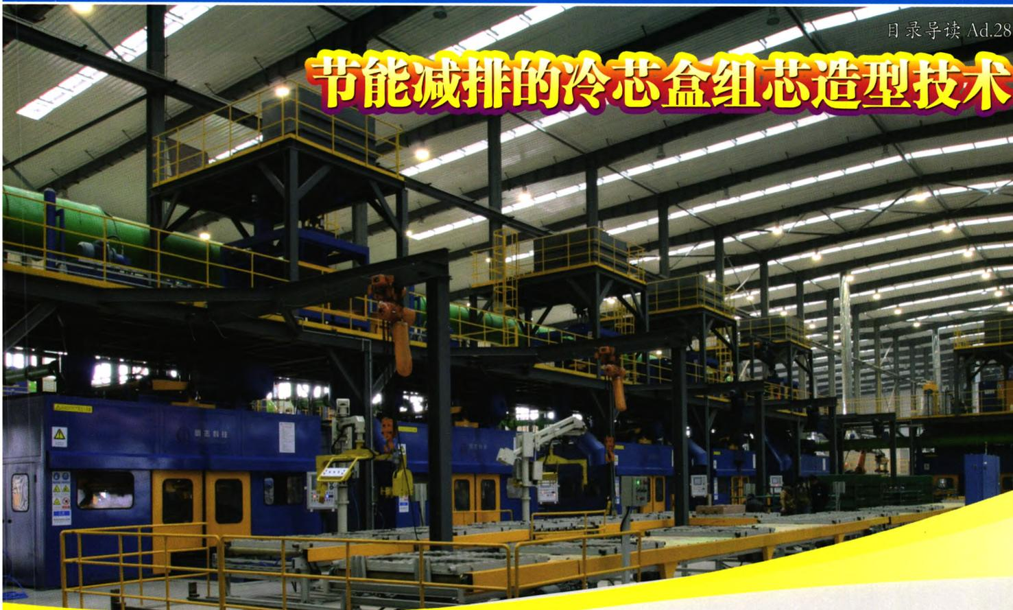
精密组芯造型工艺是采用高精度的冷芯盒砂芯进行组合造型浇注生产铸件的工艺，特点是铸件精度高（可达 CT7 级），不受砂箱限制，浇注工艺灵活，布线简便多样且效率高。尤其适用具有一定批量且铸件内腔复杂的铸件生产，而且采用单一芯砂 100% 再生便利，大大节省砂处理的投资及空间，完全可以实现铸件生产过程中造型材料的零排放，是一种具有广泛发展空间的新一代绿色环保铸造技术，该技术已被广泛地使用在铝合金发动机及其他复杂铸件上。明志科技与中国重庆机电集团成功合作，国内第一条 6 缸发动机铸铁缸体缸盖冷芯盒组芯造型生产线已投入使用。
