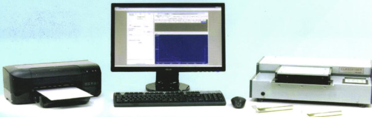
CODE 330A CLASSIFIBER TYPE W 纤维长度测试仪可自动测量各种纤维（动物、植物及合成）的长度，特别适合测试羊绒或类似的纤维。
