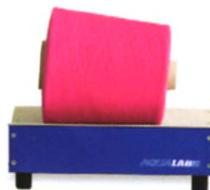
AQUA-LAB是利用创新的低频微波技术, 可即时检测纺织品的含潮率、回潮率及商业贸易重量的先进仪器, 容许在每个生产工序中进行大量测试从而控制产品的含潮率。
