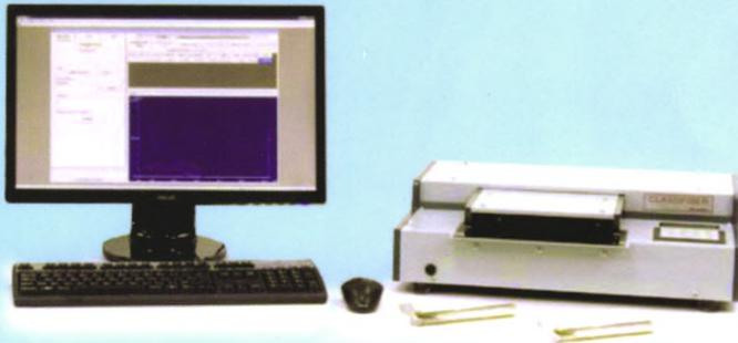
可自动测量各种纤维(动物、植物及合成)的长度, 特别适合测试羊绒或类似的纤维。
