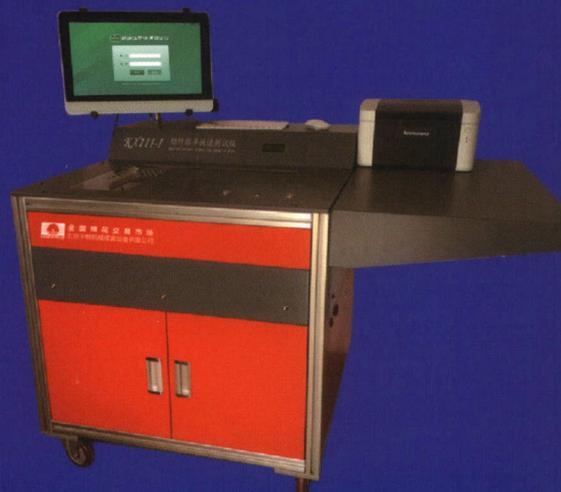
**MC101智能快速杂质分析仪**基于现有Y101、YG042的测试方法与测试原理的升级仪器，无误差。实现棉样与杂质自动称重，含杂自动计算，检测过程减少人为影响，无需干预，智能控制系统自动采集结果，自动存储并上传至云端服务器。测试速度快，100g标准棉样检测用时2分钟，棉样重量可大可小，是纤检机构在库公检、仪器化检验的替代与升级仪器。
