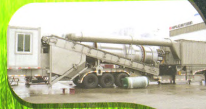
连续式冷再生 (泡沫沥青、乳化沥青)
