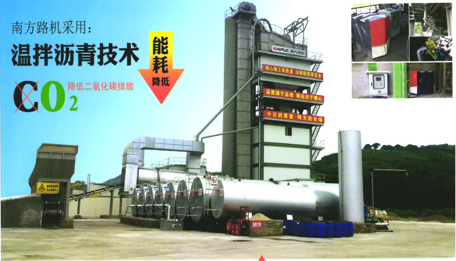
沥青厂拌热再生搅拌设备
