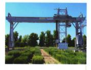
野外田间、大型温室内对植株群体表型测量 田间高通量植物表型平台Field Scanalyzer
