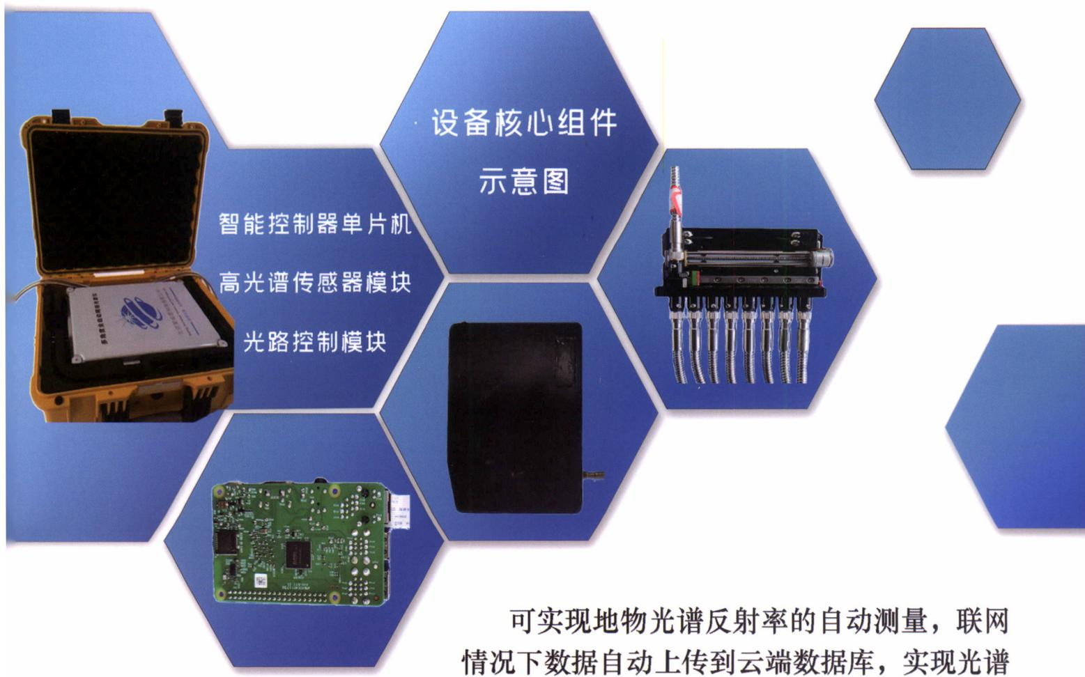
可实现地物光谱反射率的自动测量，联网情况下数据自动上传到云端数据库，实现光谱测量与地表参数反演一体化，自动完成关键生态参数实时反演；提供基于云平台的测量数据与反演参数可视化，实时监控野外测量数据；高精度光谱传感器，内置自动温度控制模块，保证野外长期运行数据稳定。
