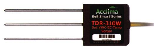
Acclima的TDR传感器是集成的时域反射计，它包含超快步进函数发生器、超快波形数字化器和精度时基。阶跃函数发生器和波形数字化仪直接连接到长度为5 cm、10 cm或15 cm的波导上，没有插入同轴电缆。他们操作的关键是一个获得专利的波形数字化硬件和固件集，其有效的数字化速率为每秒2000亿个样本。
