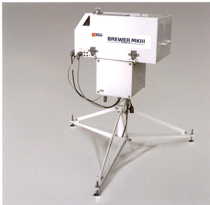
Brewer MkIII具有特殊的分光光度计设计，可自动补偿温度变化所致的元件膨胀和收缩。这意味着，它可以在世界各地的户外使用，无需复杂的温度稳定措施。仪器内置波长和灵敏度检查灯、风扇、加热器以及湿度传感器。
