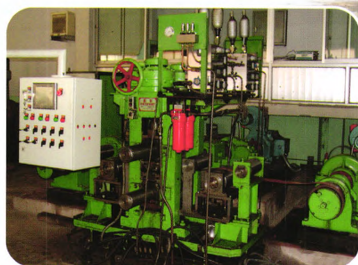
300四辊冷轧机中试平台
