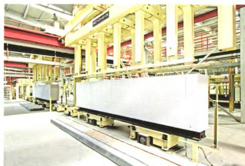
天津住宅集团新型节能建材制造基地砂加气生产线
